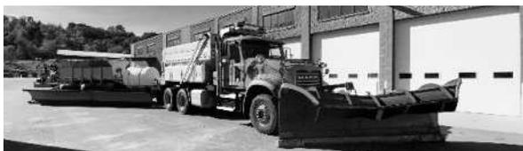
写真一1 2車線同時に対応可能な除雪車
